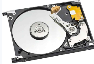
회전하는 자기 디스크에 데이터를 기록하는 HDD.
