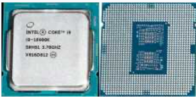
CPU 다이를 보호하고 메인보드와 연결하는 인텔 CPU 패키지.
